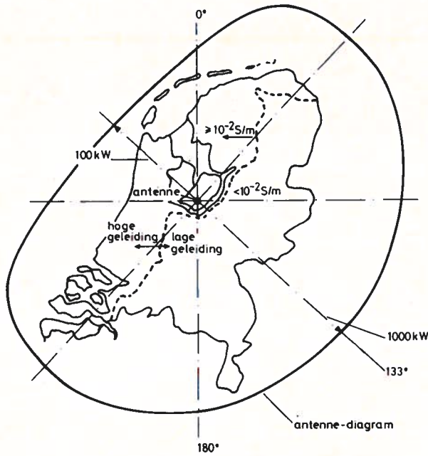
fig. 14. Horizontaal stralingsdiagram van de antennes in Flevoland.
